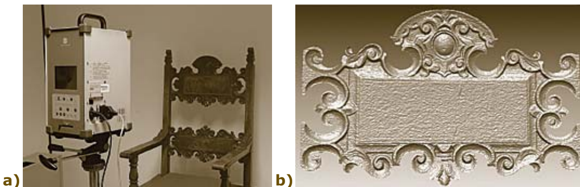
Figura 16: Modelli 3D per superfici - acquisizione di un particolare di fregio mediante scanner 3D: a) scanner 3D Konica Minolta VIVID 910; b) mesh poliedrica del fregio
