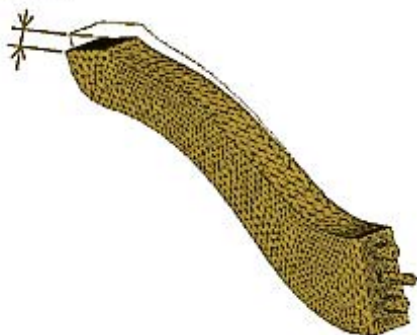
Figura 38. Confronto dei risultati delle simulazioni numeriche e delle prove statiche sperimentali su giunzione incollata
