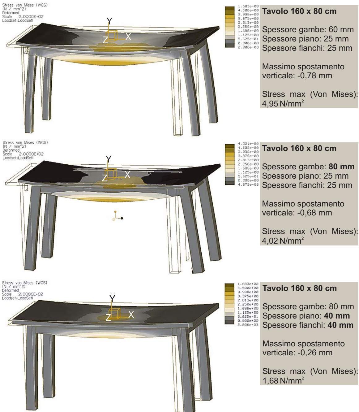
Figura 23: Esempio di prototipazione virtuale Tavolo sottoposto a carico verticale statico
